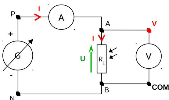
2. Remplir le tableau suivant en réalisant sept mesures de tension  $U_{AB}$  aux bornes de la photorésistance et de l'intensité  $I$  du courant qui la traverse, en faisant varier la tension aux bornes du générateur de 0 à 6 V.
