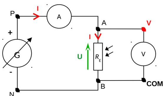
2. Remplir le tableau suivant en réalisant sept mesures de tension  $U$  aux bornes de la photorésistance et de l'intensité  $I$  du courant qui la traverse, en faisant varier la tension aux bornes du générateur de 0 à 6 V.
