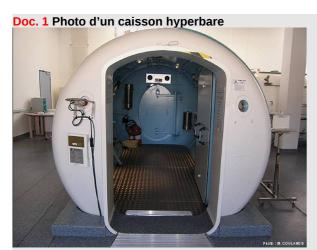
Le caisson hyperbare correspond à un cylindre étanche en acier pouvant accueillir une ou plusieurs personnes et au sein duquel la pression peut être augmentée au-delà de la pression ambiante (jusqu'à 2,5 bars, parfois plus). On rappelle qu'une surface d'aire  $1 \text{ m}^2$  au contact de l'air d'une pression de 1,5 bar subit une force 150 000 newton, c'est-à-dire une force équivalente au poids d'un objet dont la masse est de 15 tonnes.
