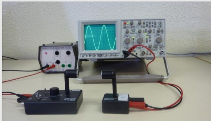
Pour vérifier la bonne détection de l'onde ultrasonore, choisir le mode continu pour  $E$  et sur l'oscilloscope les sensibilités suivantes :  $b = 5\mu\text{s}/\text{div}$  et  $k_{v1} = 0,2\text{V}/\text{div}$
