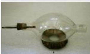
Il s'agit d'un ballon en verre ayant la forme d'un œuf muni de deux tubulures suivant son grand axe. Deux électrodes y sont insérées ; à l'intérieur de l'œuf, leurs extrémités ne sont distantes que de quelques centimètres.
