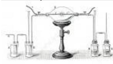
L'œuf (O) est rempli de dihydrogène. Chaque électrode (C et C') est reliée aux pôles d'un générateur électrique puissant. Lorsque le générateur fonctionne, une étincelle jaillit entre les pointes des électrodes. Un gaz est synthétisé, purifié par le passage dans les flacons et identifié comme étant l'acétylène.
