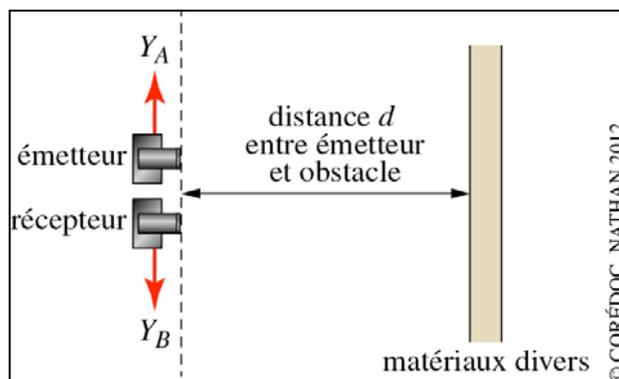
$d = V_{\text{son}} \times \frac{\Delta t}{2}$ , avec  $\Delta t$  la durée, mesurée sur l'oscilloscope, entre l'émission de l'onde ultrasonore et la réception de son écho.
