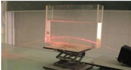
Les réfractions successives sur les différentes couches d'eau salée permettent d'expliquer la courbure du rayon lumineux vers le bas, c'est-à-dire vers les couches d'eau salée d'indice plus élevé.
